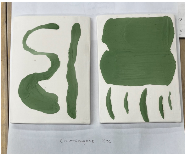
Kuvat 3 - 7. Kuvat siveltimellä levitetystä engobesta koepalan pinnalla ennen lasitetta
