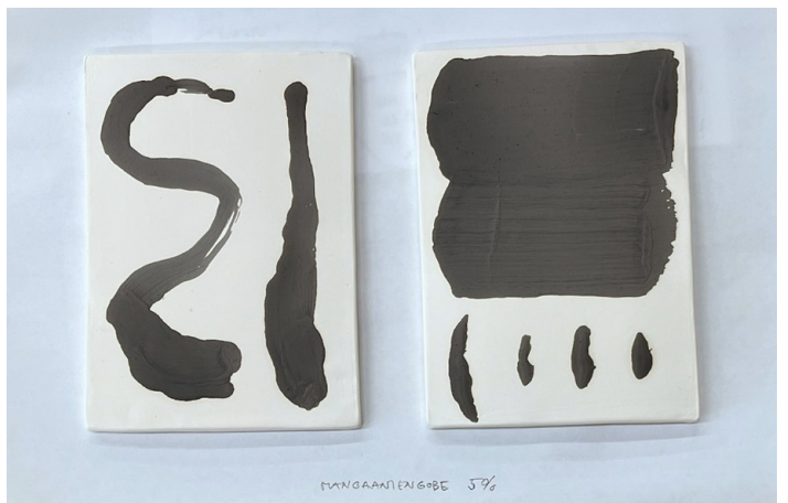
Kuvat 3 - 7. Kuvat siveltimellä levitetystä engobesta koepalan pinnalla ennen lasitetta
