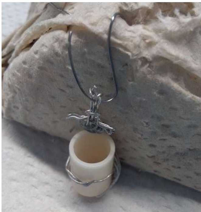
Kuva 31. Kokeissa käytetty reagoiva alumiinioksidiupokas ja platinalangasta rakennettu kori.
