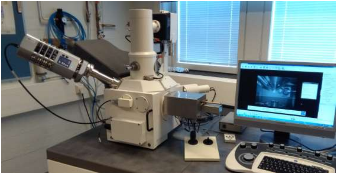
Kuva 36. Zeiss LEO 1450 SEM sekä Oxford Instruments X-Max 50 mm 2 EDS, jolla tarkastettiin alustavasti näytteiden koostumus ja faasien homogeenisuus.
