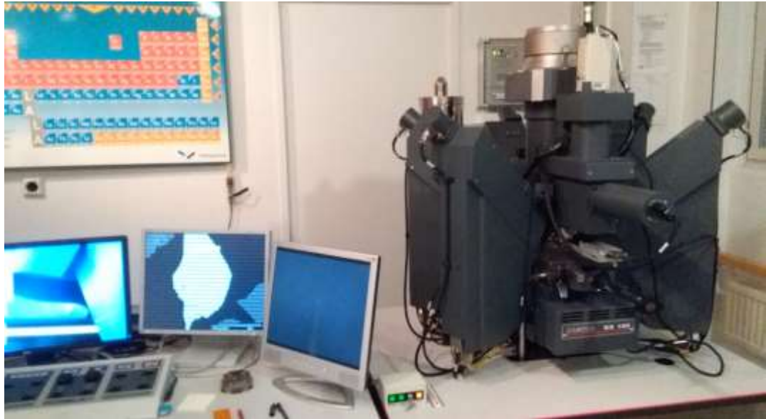
Kuva 37. Cameca SX-100 EPMA-laitteisto, johon on kytketty viisi WDS-analysaattoria.
