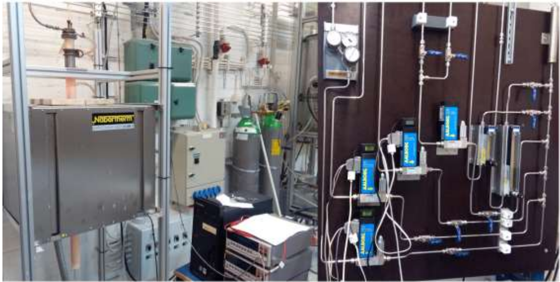
Kuva 29. Valokuva koeuunista, lämpötilanmittauslaitteistosta ja massavirtasäätimistä.
