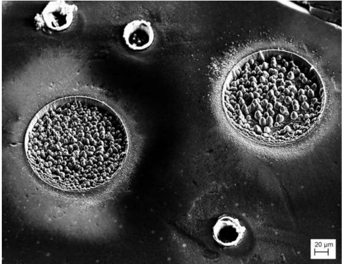
Kuva 23. Pyyhkäiselektronimikroskoopin sekundäärielektronikuva laserkuopista rautasilikaattikuonassa. Pienemmät kuopat ovat syntyneet 40 μm laserspotista, suuremmat 155 μm spotista. [118]
