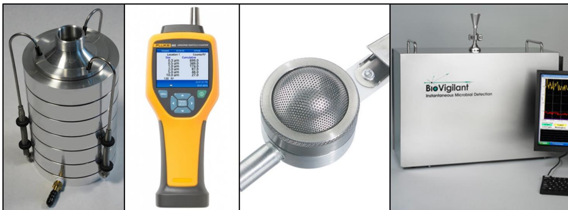
Kuva 12. Aerosolien keräämiseen ja mittaukseen käytettäviä laitteita: Andersenin keräin (Mars Bioanalytical Pvt. Ltd. 2015), Fluke 985 hiukkaslaskuri (Fluke Corporation 2015), Button-henkilökohtainen keräin (SKC Inc. 2015) ja fluoresenssiin perustuva bioaerosolihukkasten mittalaite IMD (BioVigilant 2015).
