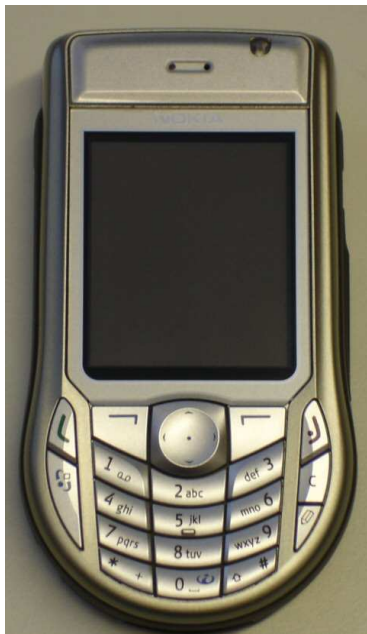
Kuva 2. Tässä työssä käytetty Nokia 6630, joka on yksi ensimmäisiä full-duplex audiota tukevista matkapuhelimista.
