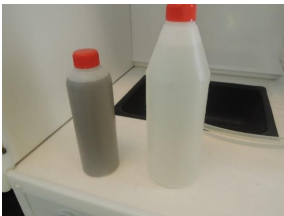
Kuva 28. Kiekkosuodattimelle tulevaa ohitusvedet (vasen pullo) ja lähtevää vettä 8 mg \text{Al}^+/\text{l} ja 3 mg/l polymeerilisäyksillä (oikea pullo).
