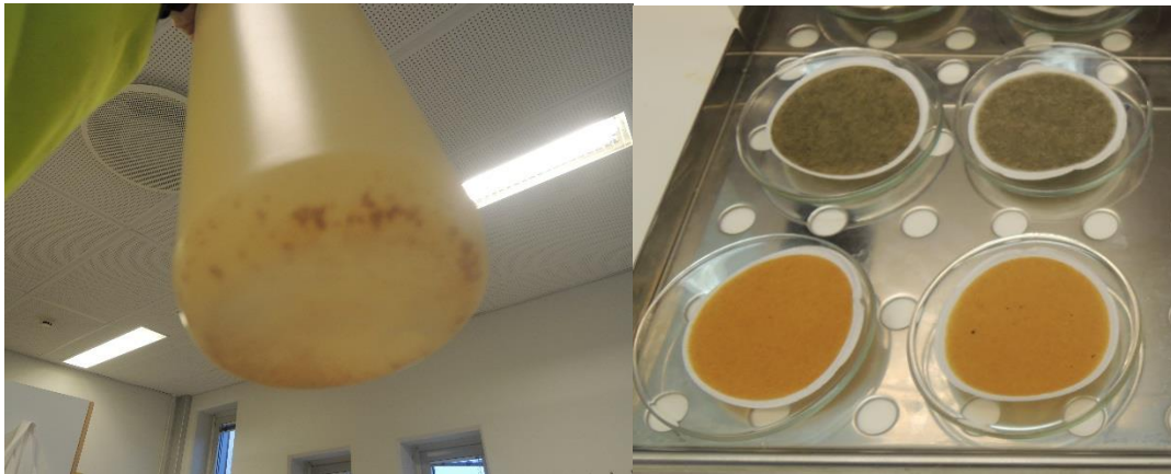
Kuva 29. Rautasakan muodostuminen kiekkosuodattimelta lähtevään esiselkeytettyyn veteen (vasen kuva). Oikeassa kuvassa kiintoainepapereita kiekkosuodattimelle tulevasta esiselkeytetystä vedestä (paperit ylhäällä) ja kiekolta lähtevästä vedestä (paperit alhaalla).
