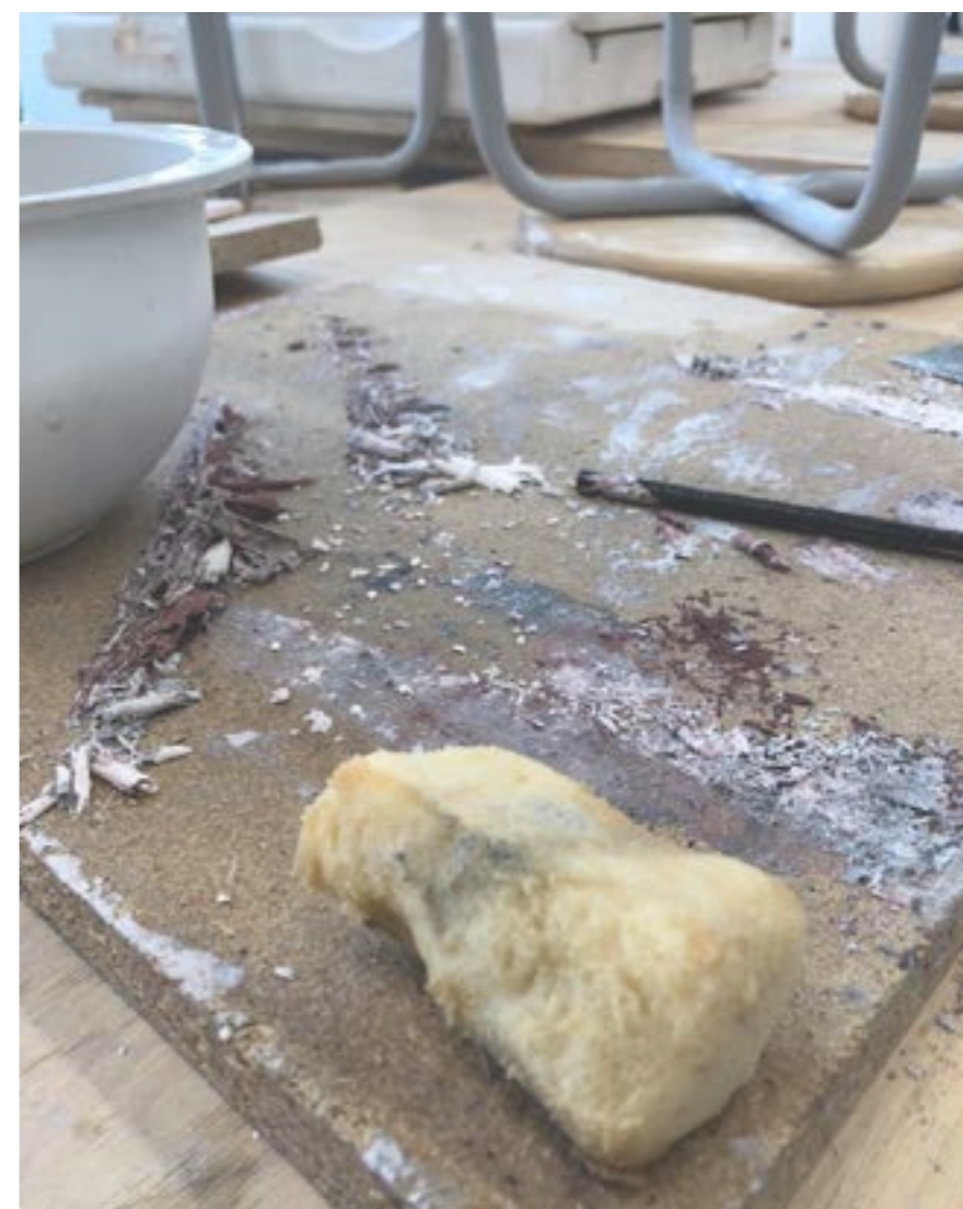
Kuva 18. Testilaattojen siistiminen. Keraamisen kappaleen pinnasta poistetaan ylimääräinen lasiteaines, joka muuten saattaisi tarttua uunilevyyn lasituspolton aikana.
