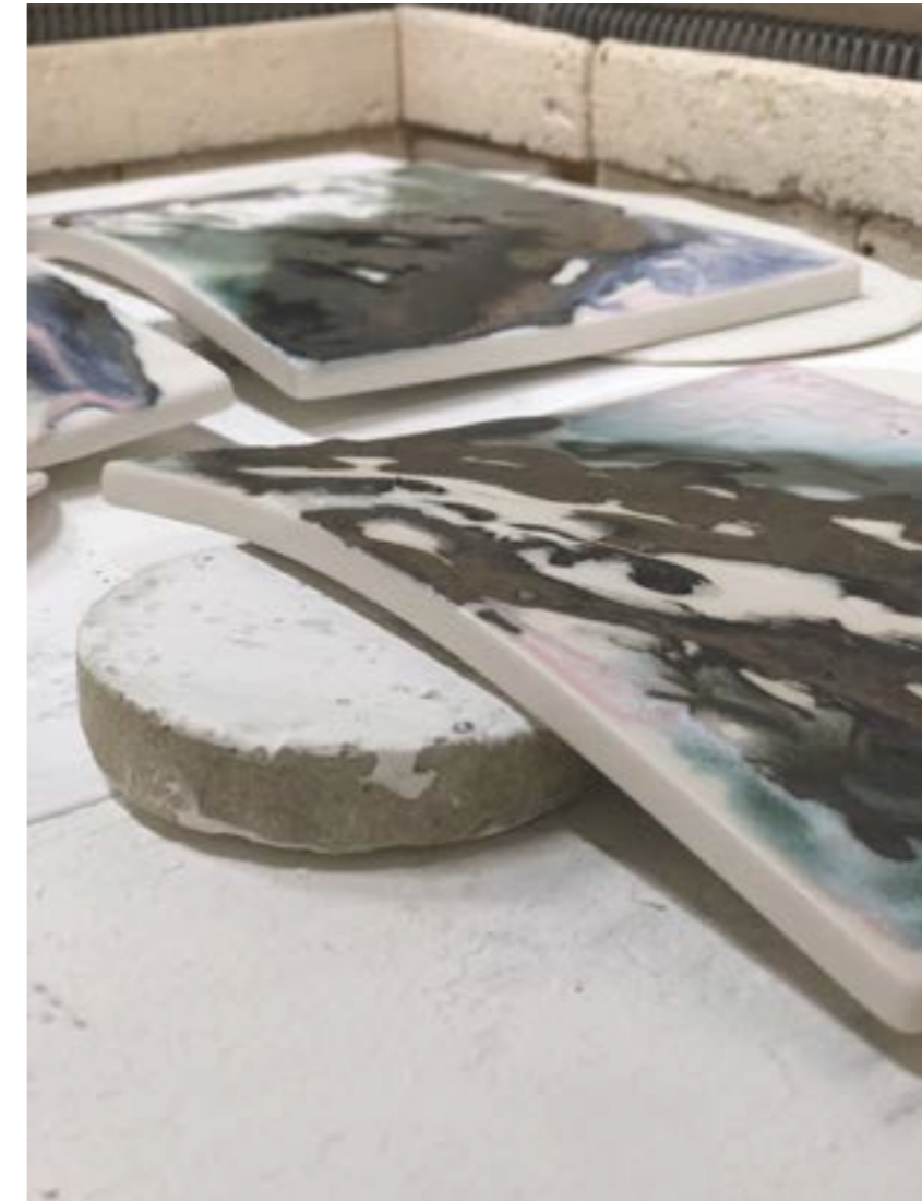
Kuva 51. Toisen testisarjan posliinilaattojen vääntymät.
