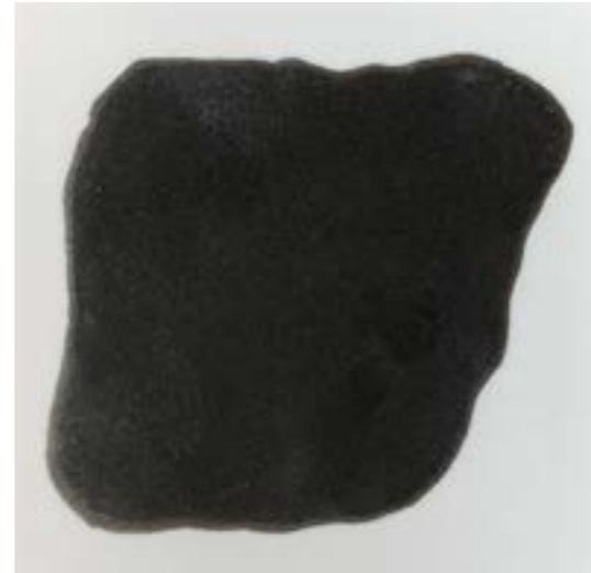
Kuva 8. Rusehtavan musta mattapintainen lasite. Poltettu 1280 °C:ssa. Lasite koostuu sulattajista sekä värimetallioksiedeista.
