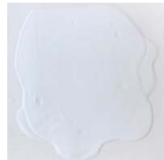
Kuva 12. Opaali valkoinen, mattapintainen lasite. Poltettu 1280 °C:ssa. Kaoliini tekee lasitteeseen sille ominaisen puhtaanvalkoisen värin.
