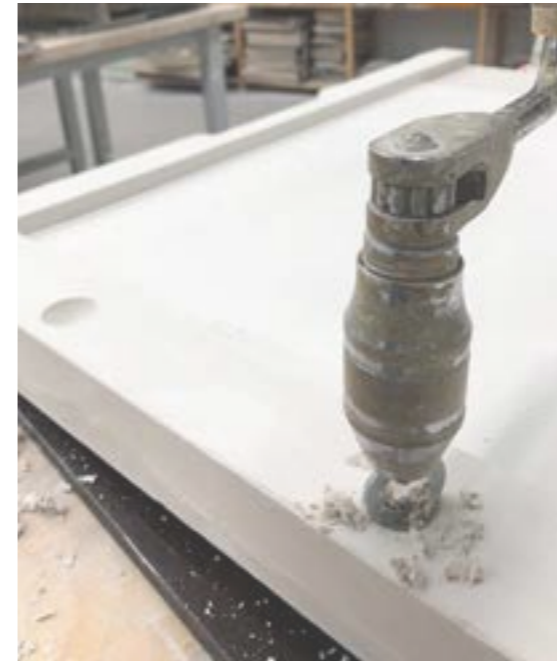
Kuva 4. Suuren levymuotin rakennusta kipsistä. Kuvassa teen kipsimuottiin lukkoja, jotka pitävät muotin puoliskoja paikallaan oikeassa kohdassa valun ajan.
