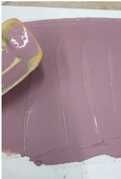
Kuva 4: Massan kuivatus kipsialustan päällä.
