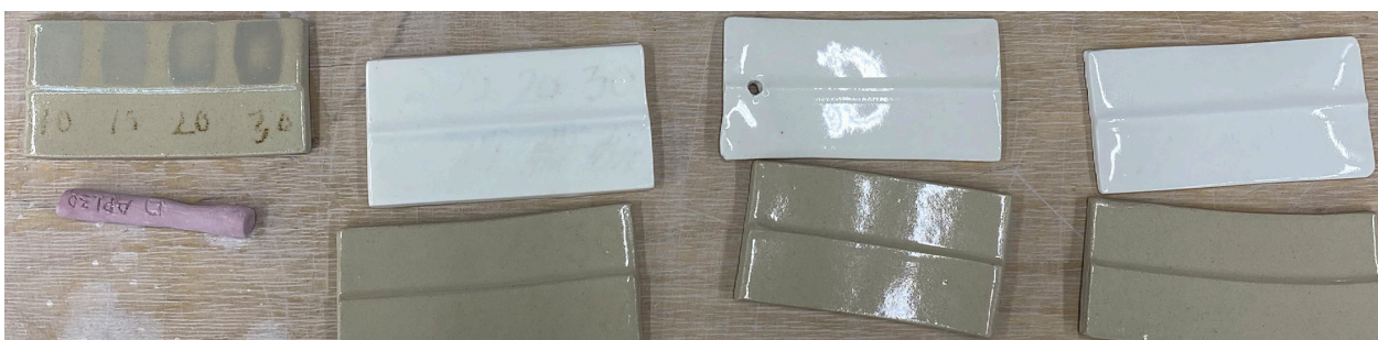
Kuva 13: Vaaleanpunainen pigmentti on palannut pois korkeassapoltossa.
