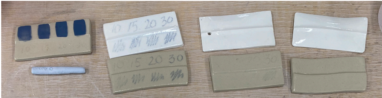
Kuva 10: Sinertävän harmaa sävy näkyy parhaiten polttamattomilla liiduilla tehdyllä koepalalla.
