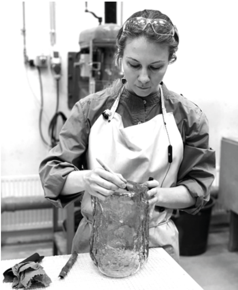
Tässä piirrän tussilla hiottavan esineen reunaan. Tällä varmistan että materiaalia lähtee joka puolelta tasaisesti
