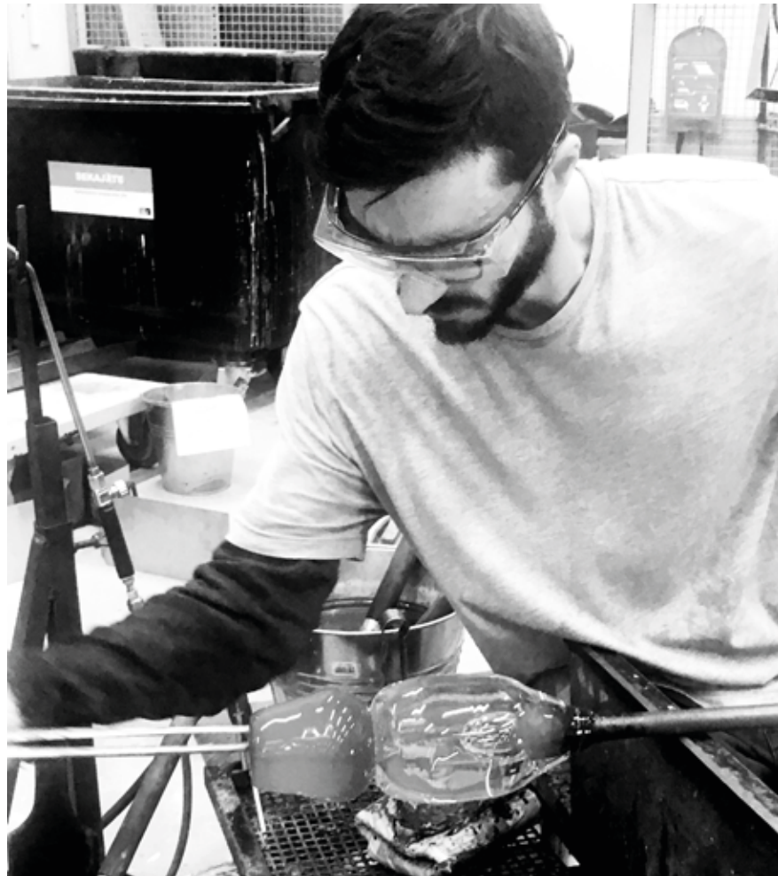
Puhaltaja Erdem toteuttaa Swedish overlay -tekniikkaa. Tässä kuvassa hän on juuri poiminut värikuplan kirkkaan kuplan päälle ja pihtien avulla avaa väriä sisältävän kuplan kirkkaan lasin päälle.
