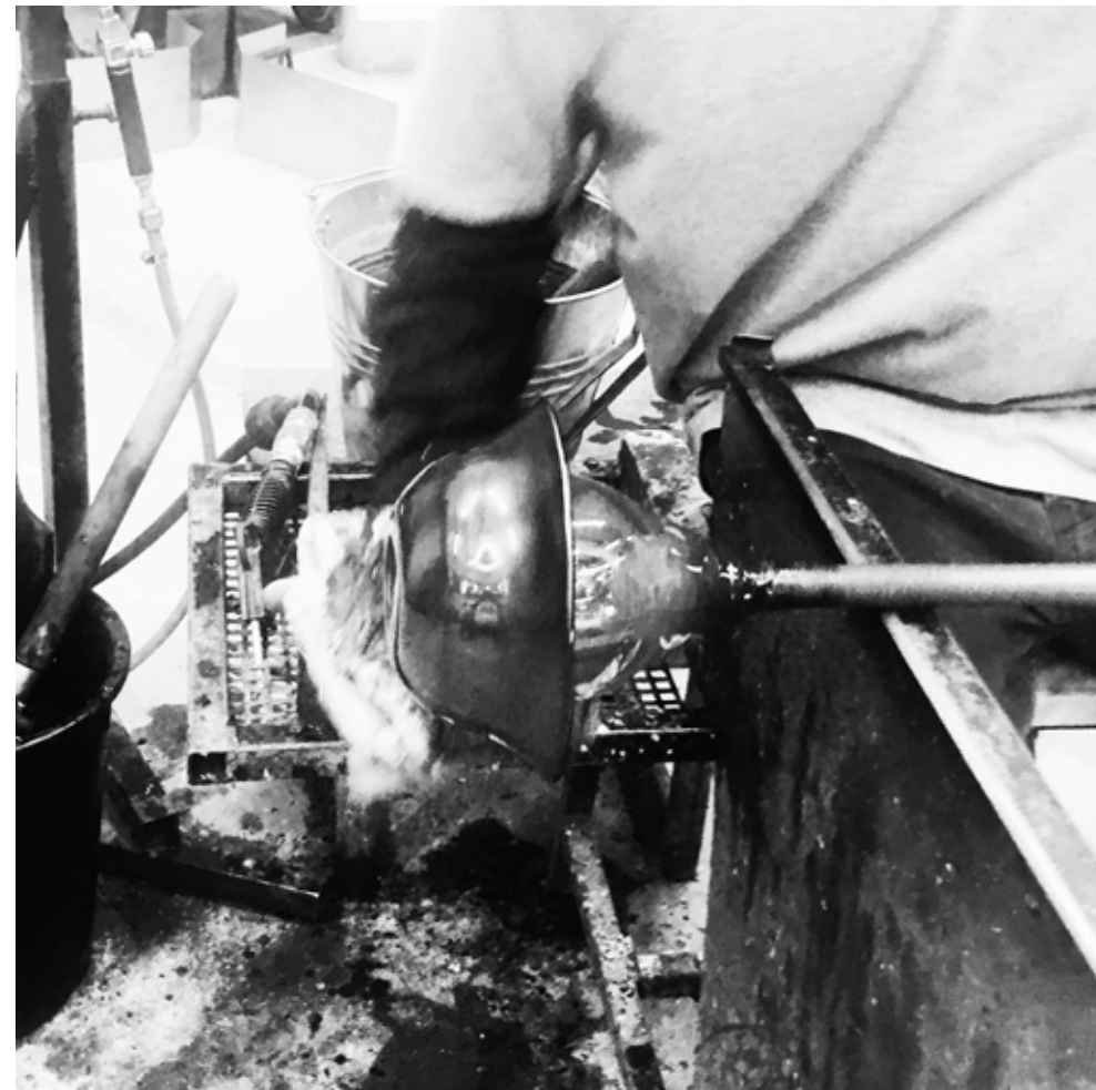
Väriä sisältävää kuplaa venytetään varovasti kirkkaan lasikuplan päälle.
