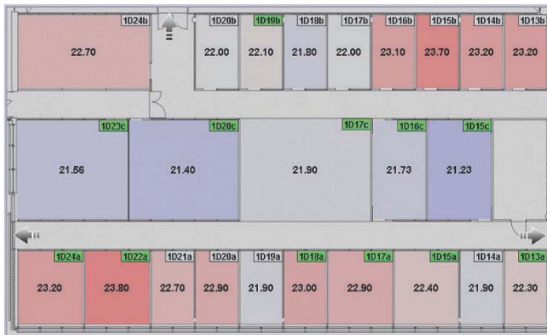
Kuva 19. Lämpötilat rakennuksen eri tiloissa. (ST 98.50, 2010, 13)
