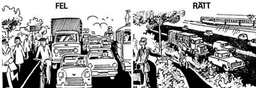
Kuva 1: Liikennemuotojen erotteluperiaate SCAFT-mallissa (Gunnarsson & Lindström, 1970). Vasemmalla fel , väärin, kuvaa ei-toivottua järjestelyä ja oikealla rätt , oikein, kuvaa toivottua järjestelyä.
