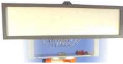
Figure 3: Polarimetric Uniform Linear Patch Array (PULPA) with N = 8 patch sensors (TU-Ilmenau).
