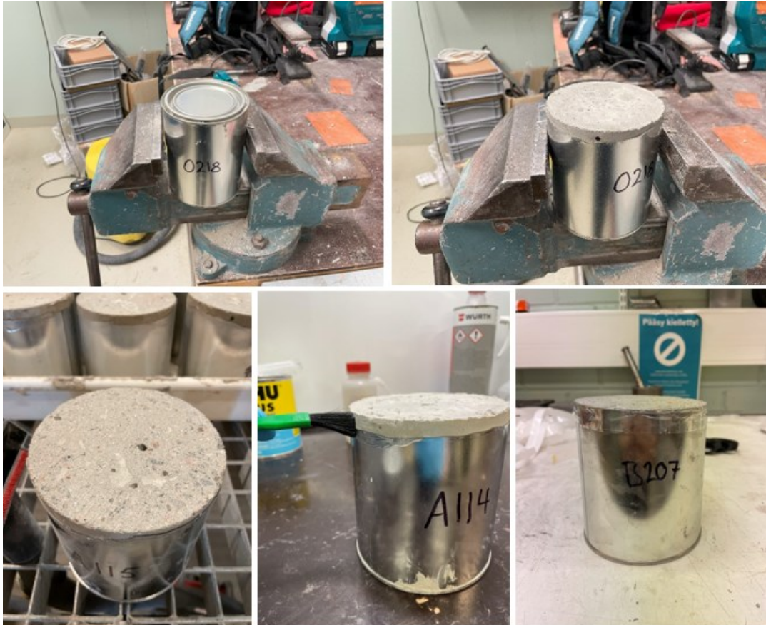
Kuvat 14a-e. Koekappaleiden valmistusvaiheet: a-b. metallireunan poisto, c. betonin pinnan aukaisu, d. muotin ja betonin liittymän tiivistys epoksisivelyllä ja e. alumiiniteipin asennus muotin ja betonin liittymän päälle.
