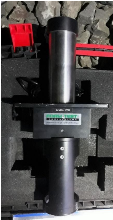
Kuva 28. Tartuntavetolujuuden mittaamiseen käytetty HZP-ConsurTest –mittauslaite.
