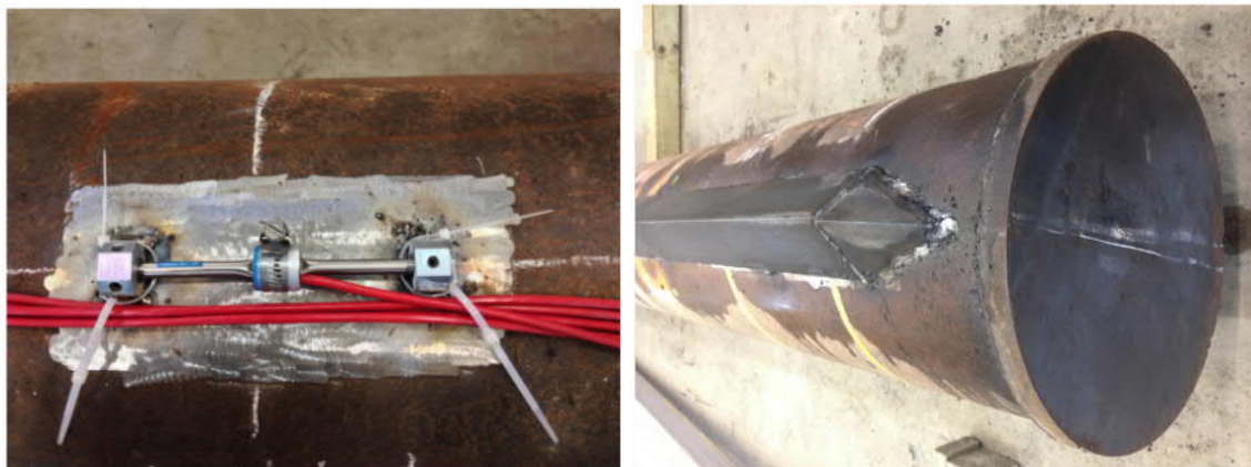
Kuva 21: Rakenteen pintaan hitsattava värähdyslankavenymäanturi asennettuna teräsputkipaaluun ja hitsattu teräskotelo venymäantureiden suojana (Han et al. 2016).
