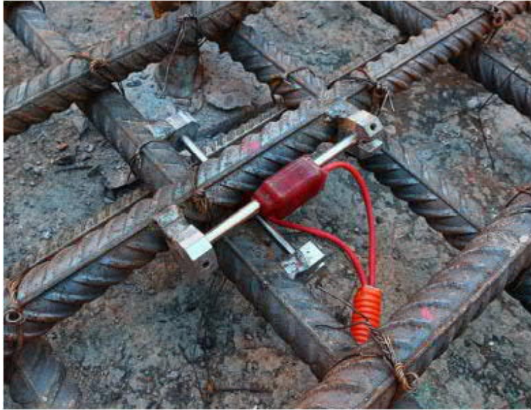
Kuva 38: Esimerkki pohjalaattaan asennetuista värähdyslankavenymäantureista (Travush et al. 2018).
