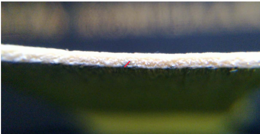
Kuva 13. Kääntämätön pinta puristuksen jälkeen. Sorvaushalkeamat alapuolella
