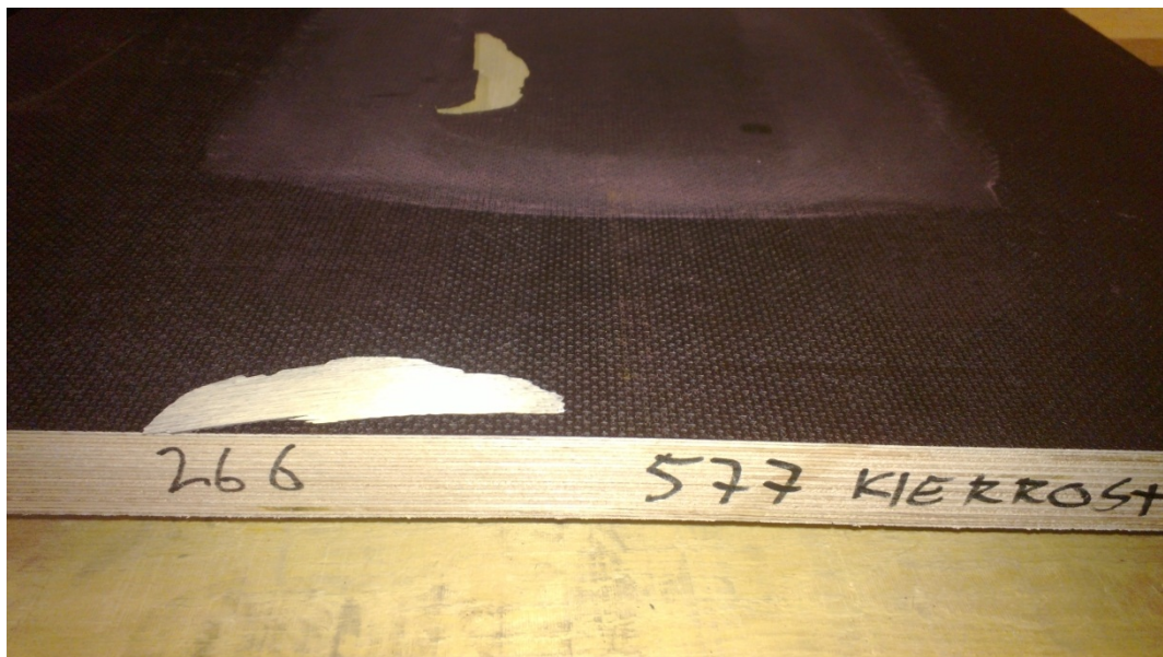
Kuva 28. Pinnan rikkoutuminen jyräyksen vaikutuksesta
