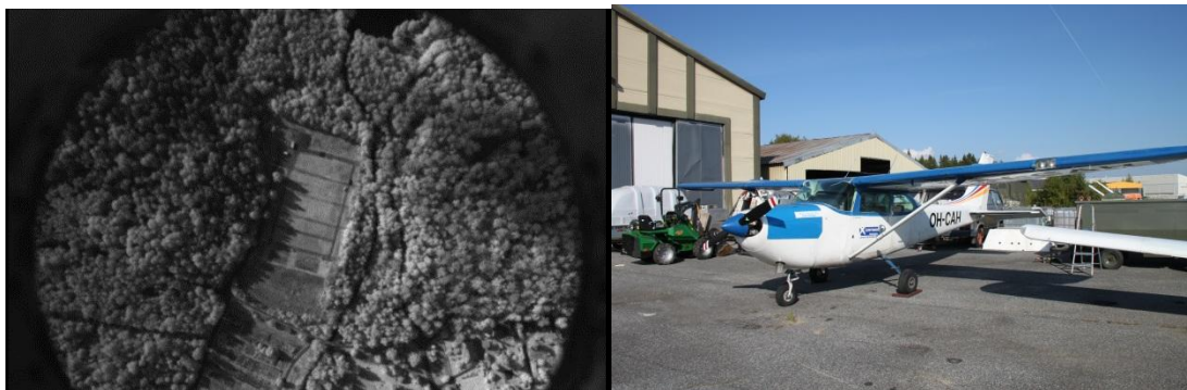
Kuva 8 Vasemmalla esimerkkikuva lähi-infran (829,2 nm) alueelta. Oikealla kuvauksessa käytetty Cessna Cardinal RG –pienkone kuvattuna heti kuvausten jälkeen (© Teemu Hakala).
