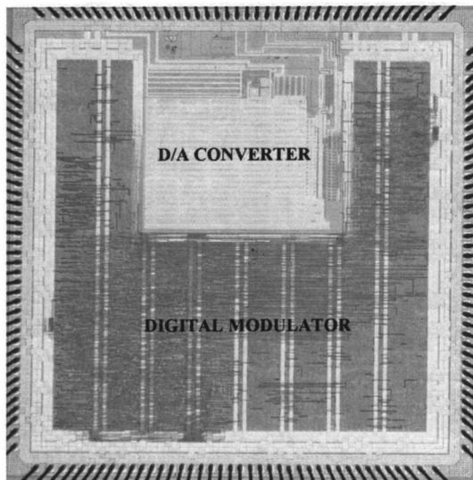
Fig. 18. Chip micrograph.
