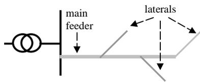
Fig. 8. MV feeder.
