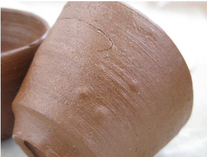
Kuva 8. käsittelemättömässä massassa näkyy juuresta syntynyt viilto ja massan epätasaisuudesta johtuvia kohoumia
