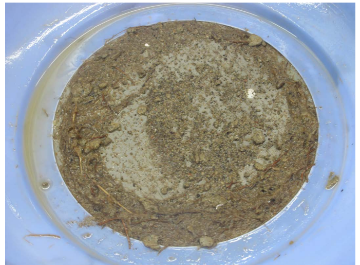
Kuva 4. 60 meshin siivilään jääneet epäpuhtaudet
