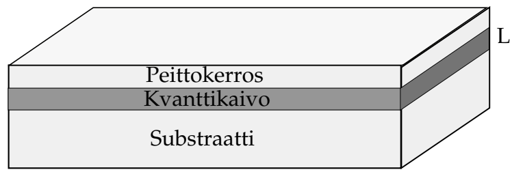
Kuva 2.4. Periaatekuva kvanttikaivosta, jonka paksuus on L .
